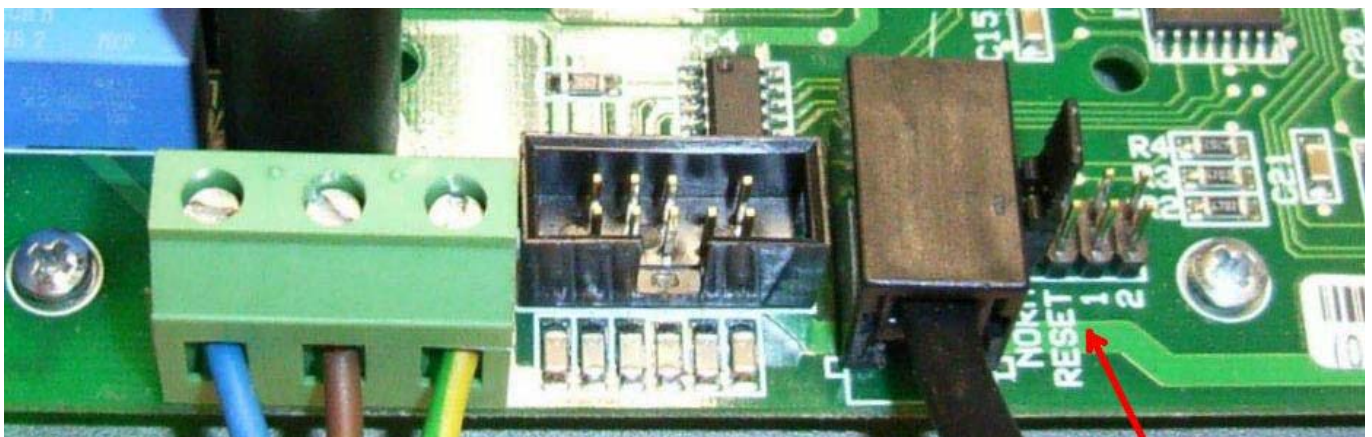
cavalier de reconfiguration (jumper)
